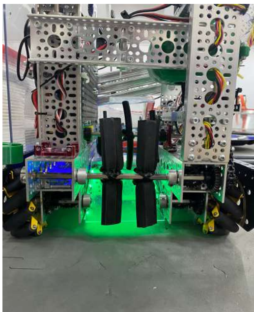
poză cu versiunea finală de intake și rampă de acrilic
