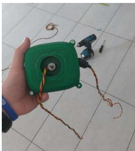
Carcasa ruletei printată în varianta finală
