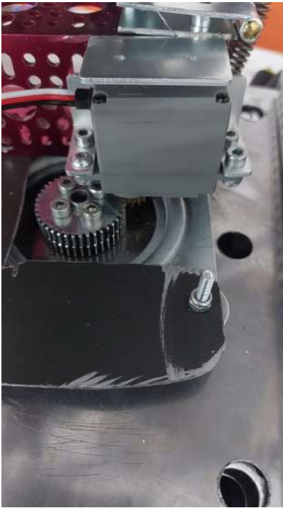
prima iterație a rotirii turetei, angrenată de un servo
