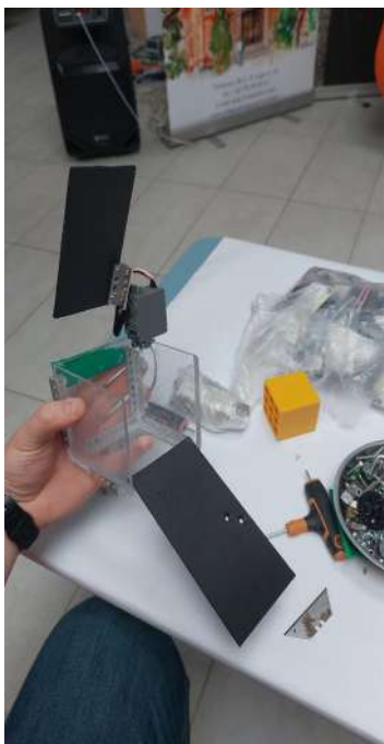
cutie cu flaps din plexiglas și PVC
